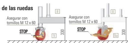
Las ruedas sin regulación **9** son inmobilizadas accionando el freno, pisando la palanca del mismo. Durante el uso, montaje y desmontaje las ruedas con regulación **9a** deben bloquearse accionado el freno. Si el freno está accionado la palanca STOP quedará presionada hacia abajo.
